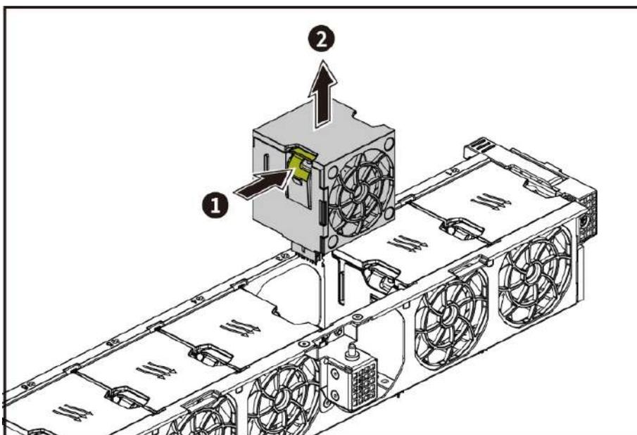
Рисунок 38 – Демонтаж одного вентилятора
