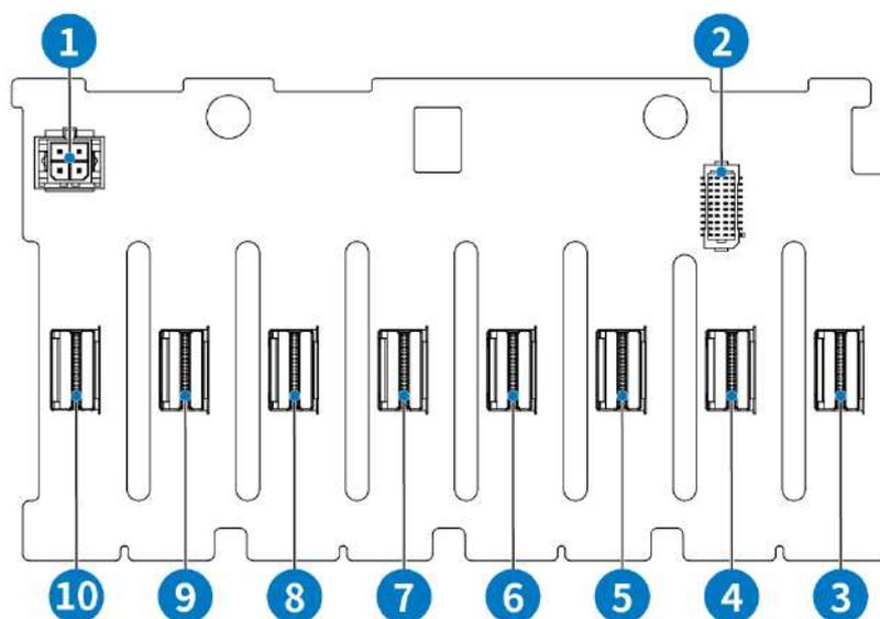
Рисунок 8 – Бэмплейн (кроссплата) Тринити (на 8 накопителей). Вид сзади
