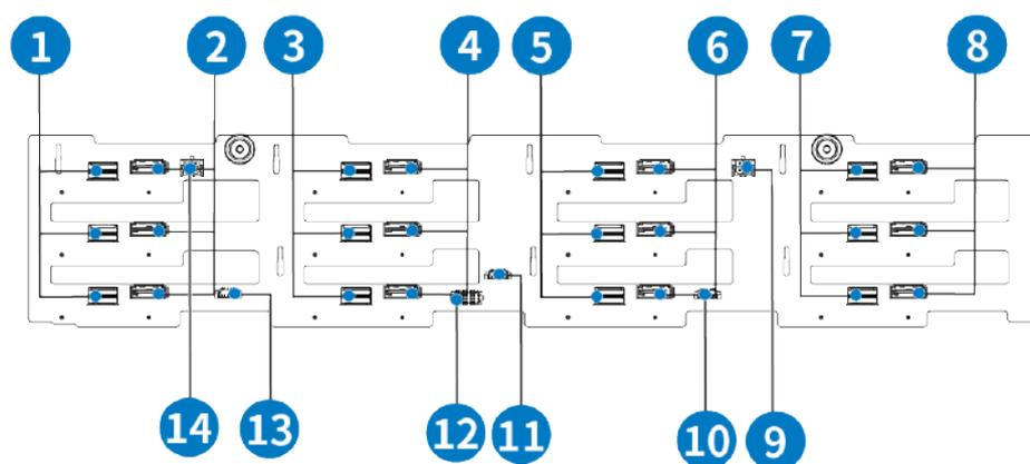
Рисунок 6 – Бэкплейн (кроссплата) Тринити (на 12 накопителей). Вид сзади
