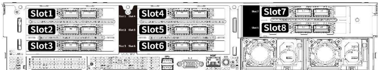
Рисунок 18 – Расположение слотов PCIe (8 шт.)
