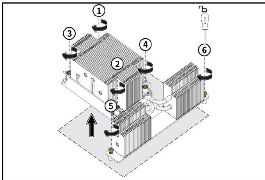
Рисунок 59 – Демонтаж радиатора
