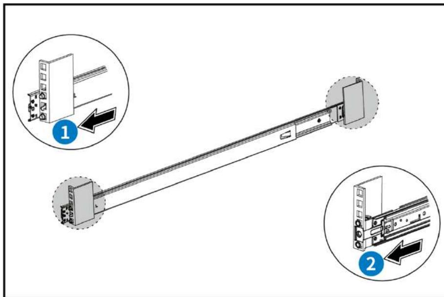
Рисунок 22 – Установка направляющих
