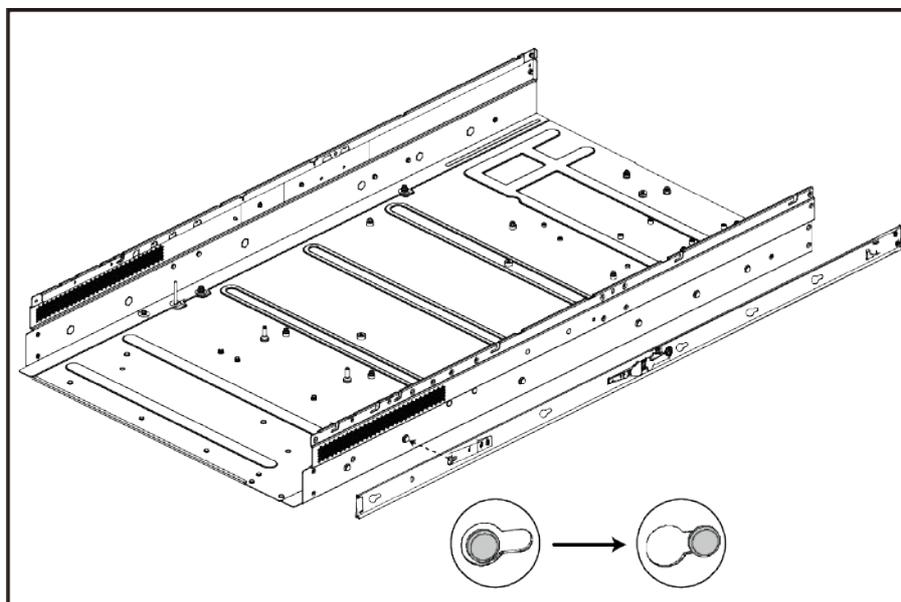
Рисунок 24 – Установка внутренних подвижных рельс на корпус сервера
