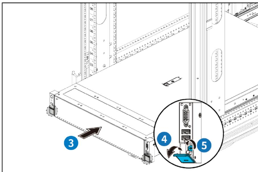
Рисунок 21 – Установка сервера на направляющие шкафа
