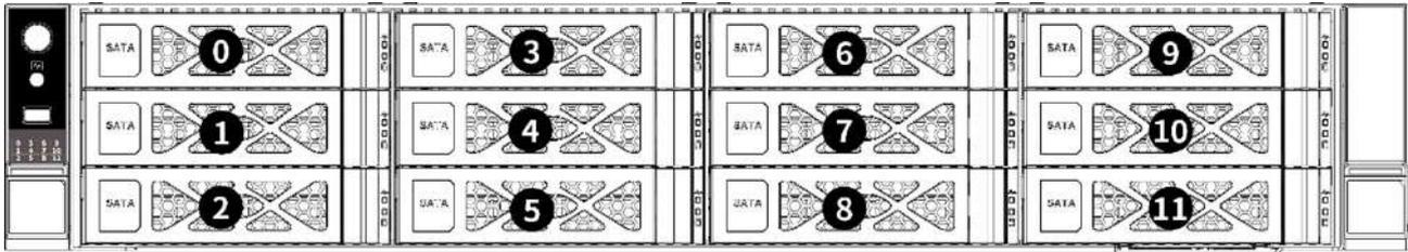
Рисунок 15 – Отсеки передней панели сервера (для 12 накопителей LFF)
