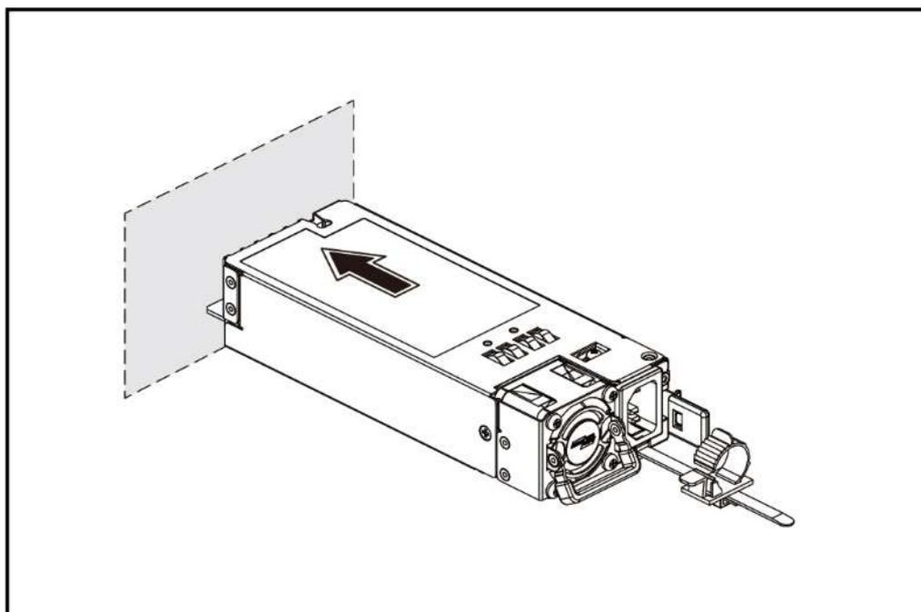
Рисунок 32 – Установка блока питания
