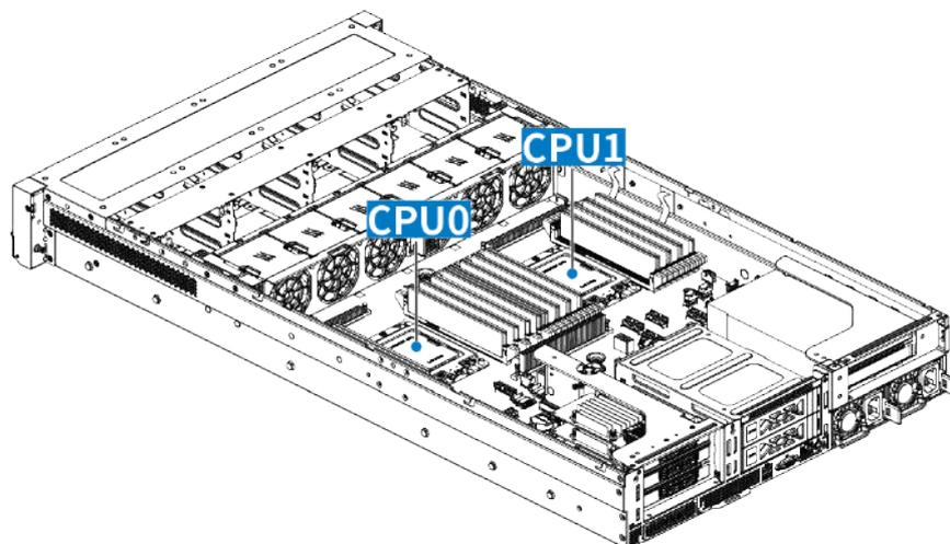
Рисунок 12 – Расположение процессоров
