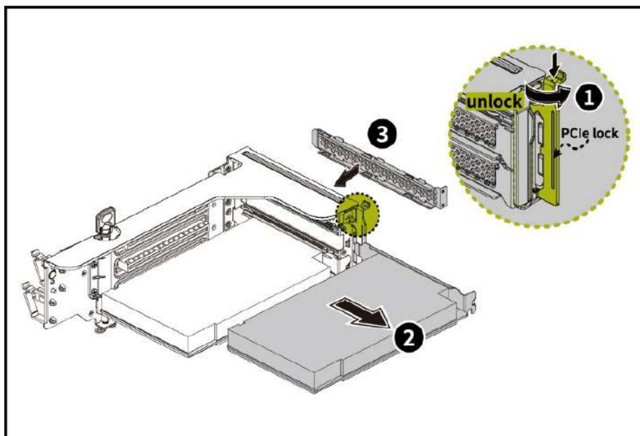
Рисунок 49 – Извлечение сетевой карты из модуля 3PCIe
