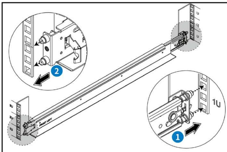
Рисунок 20 – Установка направляющих
