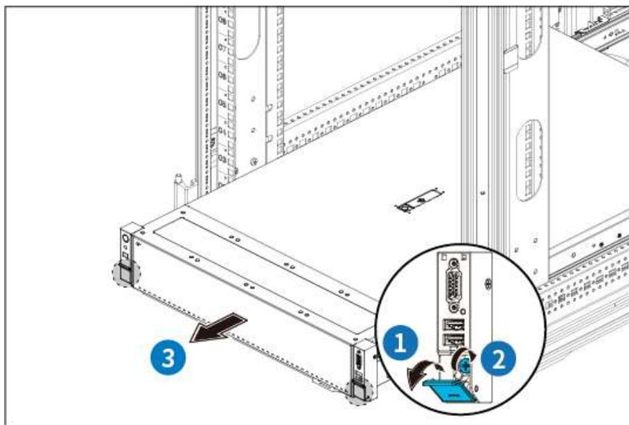
Рисунок 19 – Извлечение сервера из шасси стойки (шкафа)
