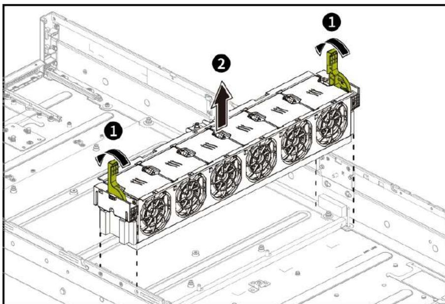
Рисунок 37 – Снятие блока вентиляторов
