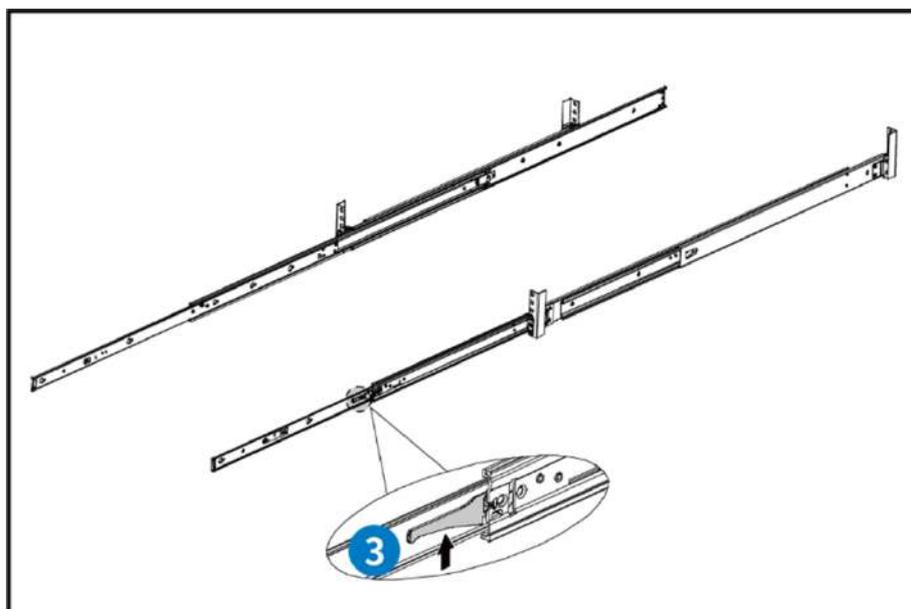
Рисунок 23 – Установка направляющих
