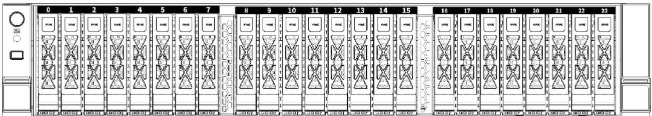
Рисунок 16 – Отсеки передней панели сервера (для 24 накопителей NVMe)
