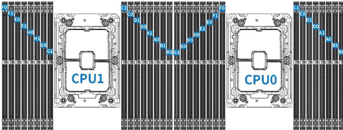
Рисунок 13 – Расположение слотов на материнской плате сервера
