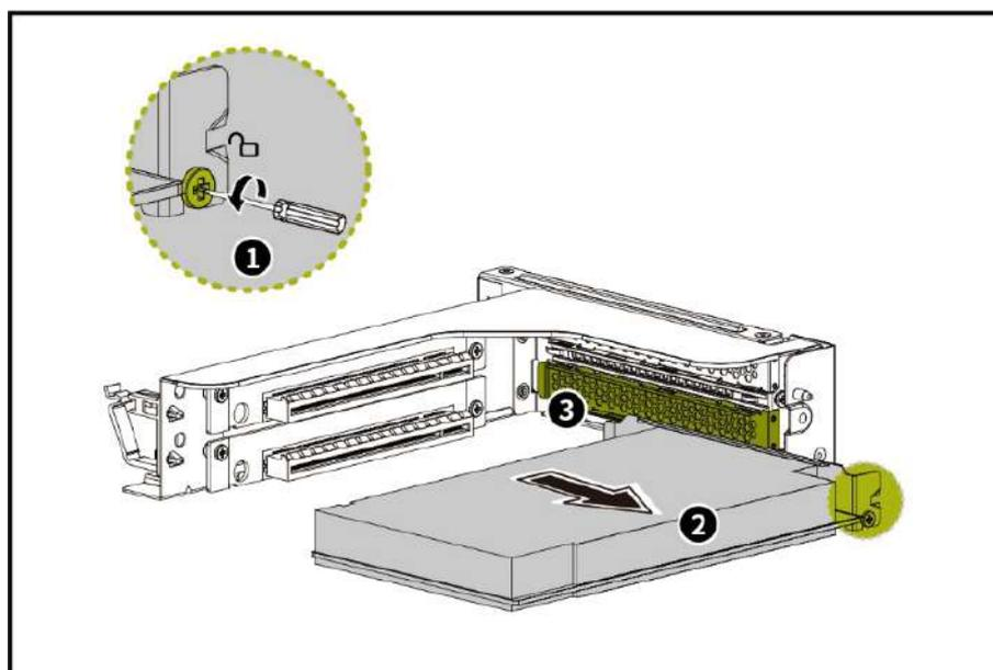
Рисунок 51 – Извлечение сетевой карты из модуля 2PCIe
