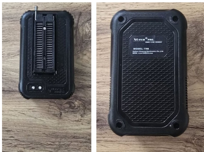
XGecu T48: вид сверху и оборот с маркировкой модели
